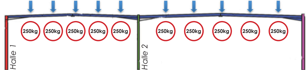
Cas n°4 Halle 1 : charges ponctuelles de 250kg écartées de 2,45m les unes des autres. Halle 2 : charges ponctuelles de 250kg écartées de 2,45m les unes des autres.
