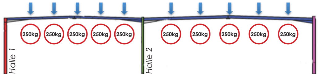
Cas n°4 Halle 1 : charges ponctuelles de 250kg écartées de 2,45m les unes des autres. Halle 2 : charges ponctuelles de 250kg écartées de 2,45m les unes des autres.
