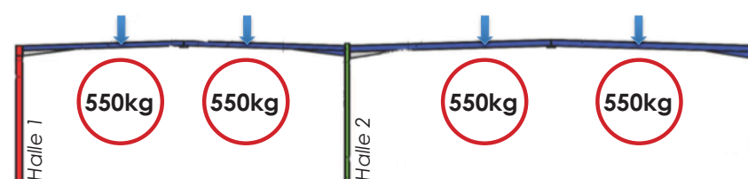
Cas n°2 Charges ponctuelles de 550kg situées à mi-portée de la traverse en sortant du faitage.
