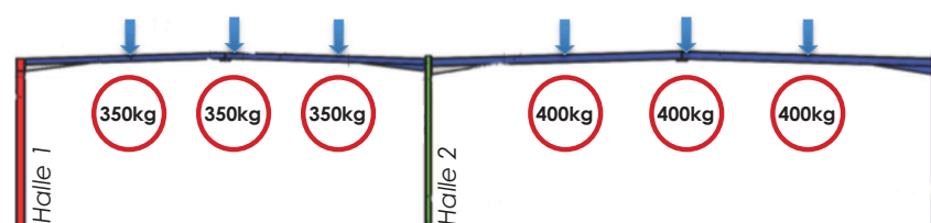
Cas n°3 Halle 1 : charges ponctuelles de 350kg situées mi-longueur de la traverse et au faitage. Halle 2 : charges ponctuelles de 400kg situées mi-longueur de la traverse et au faitage.
